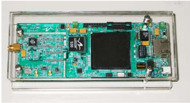
図1 UWB応用機器デザイン・キット インターフェースは100Base-TのイーサネットとUSB1.1を備える。外部機器への入出力を含めた伝送速度は100Mビット / 秒。
